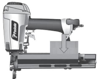
**Paso 3:** Cuando la flecha aparezca en el área de recarga, marcada en el lado del cargador, usted puede introducir una nueva tira de clavos. Cuando la flecha del seguidor alcance el área de bloqueo, la herramienta se bloquea automáticamente para evitar su funcionamiento. Para desenganchar la herramienta, recargue simplemente otra tira de clavos.
