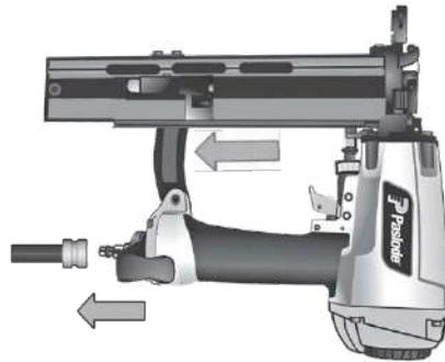
**Étape no 2 :** Insérer la bande d'agrafes dans le rail du magasin.
