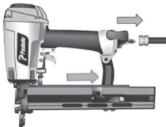
**Paso 2:** Tire del seguidor hacia la parte posterior del cargador hasta que el seguidor haya pasado la última tira de clavos. Suelte la palanca del seguidor y deje que el mismo mueva los clavos hacia adelante dentro de la boca de la herramienta.
