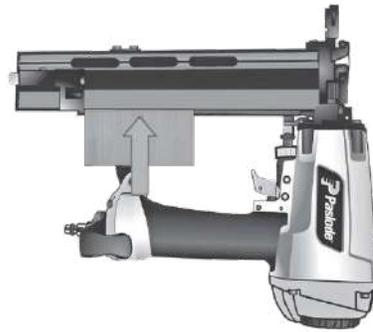
**Étape no 3 :** Appuyer sur le levier de libération du loquet du pourvoyeur ou libérer le pourvoyeur et le faire glisser vers l'avant jusqu'à ce qu'il touche la bande d'agrafes. Rebrancher l'alimentation en air. L'outil est maintenant prêt à être utilisé.
