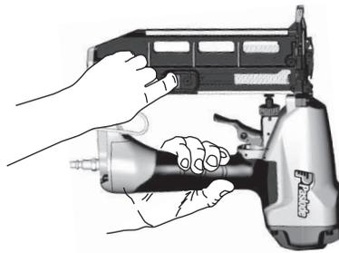
Lorsque le pourvoyeur atteint la zone de recharge, marquée sur le côté du magasin, vous pouvez insérer une nouvelle bande d'attaches. Lorsque la flèche du pourvoyeur atteint la zone de verrouillage, l'outil se verrouille automatiquement, pour prévenir tout fonctionnement de l'outil. Pour débloquer l'outil, recharger simplement une autre bande d'attaches.
