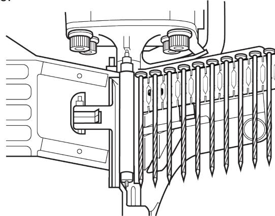
**Paso 4:** Cierre la tapa del cargador y luego la puerta asegurándose de que la puerta quede trabada con seguridad.
