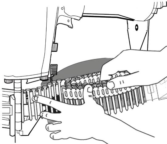
**Paso 3:** Presente el rollo de clavos con la banda libre sobre el mecanismo transbordador y oriente el primer apertura de la banda entre la uña transbordador y guía para colocar el primer clavo en posición de descarga.
